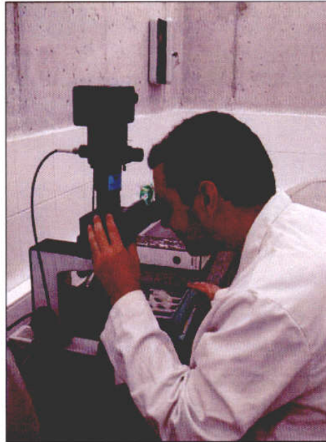
Foto 1.7.- Equipo empleado para la observación de láminas delgadas en el Centro Tecnológico del Mármol.
