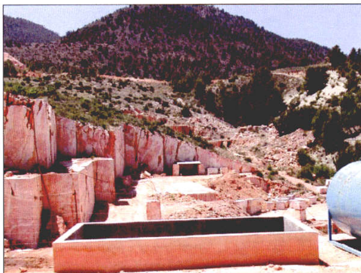
Foto 2.17.- Cantera en la sierra del Quipar donde se aprecia el buzamiento de la capa explotable. Actualmente abandonada.
